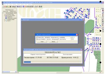
расчет распределения температур по всем узлам тепловой сети произвольной конфигурации и структуры при заданном потокораспределении и температурах теплоносителя на источниках;
